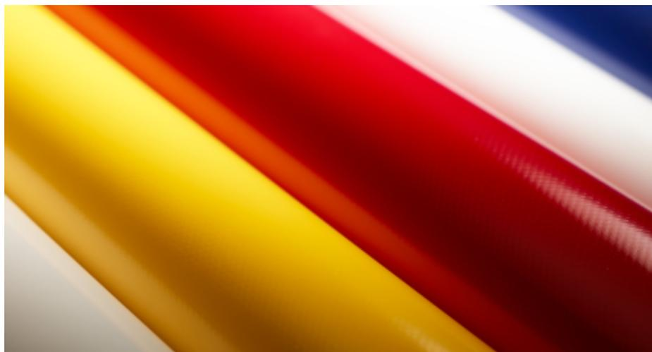
Tissu polyester ennoblé hautement résistant enduit d'un revêtement PVC souple avec une haute stabilité aux UV. Sa longévité et sa parfaite résistance aux salissures sont garanties par un film de protection sur la surface spécialement développé pour ce produit. Le produit répond aux exigences définies par la norme DIN EN 12 641-1 pour les caisses mobiles de camion.
